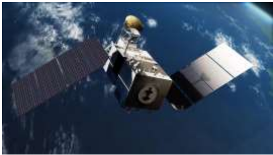
图 11 FY-3G 降水卫星 Figure 11. FY-3G Precipitation Satellite FY-3G 卫星以降水为主要观测目标，所配置的 业务遥感仪器包括：主动降水测量雷达 （Precipitation Measurement Radar, PMR）、被动微
