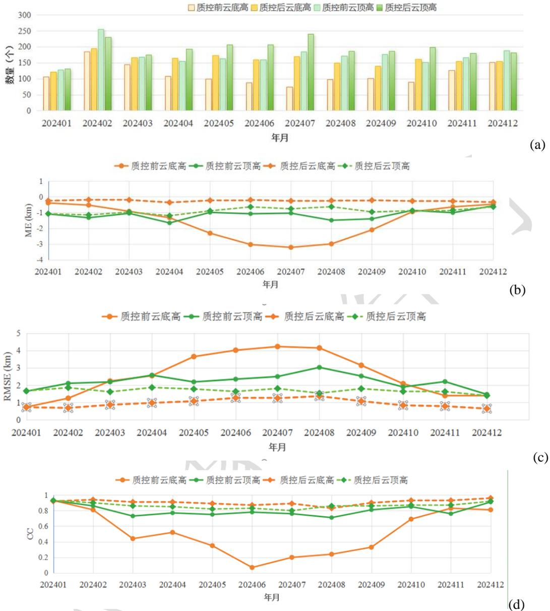
图 7 测云仪反射率因子数据质量控制前后与探空反演云底、云顶高度的逐月对比时序图
