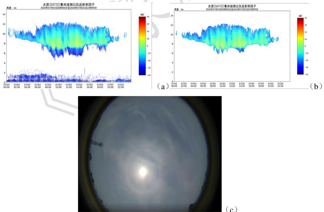
图4 2024年7月3日0—24时，太原站质量控制前(a)、质量控制后(b)测云仪反射率因子，以及2024年7月3日4时，太原站全天空成像仪(c)观测实景
