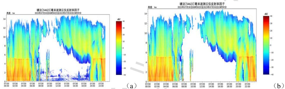
图 5 2023 年 7 月 30 日 00 时-31 日 00 时，塘沽（54623）站质量控制前 (a)、质量控制后 (b) 测云仪反射率因子时序图
