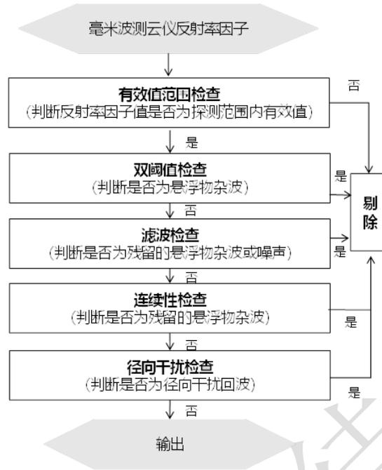
图 2 毫米波测云仪反射率因子要素质量控制方法流程图
