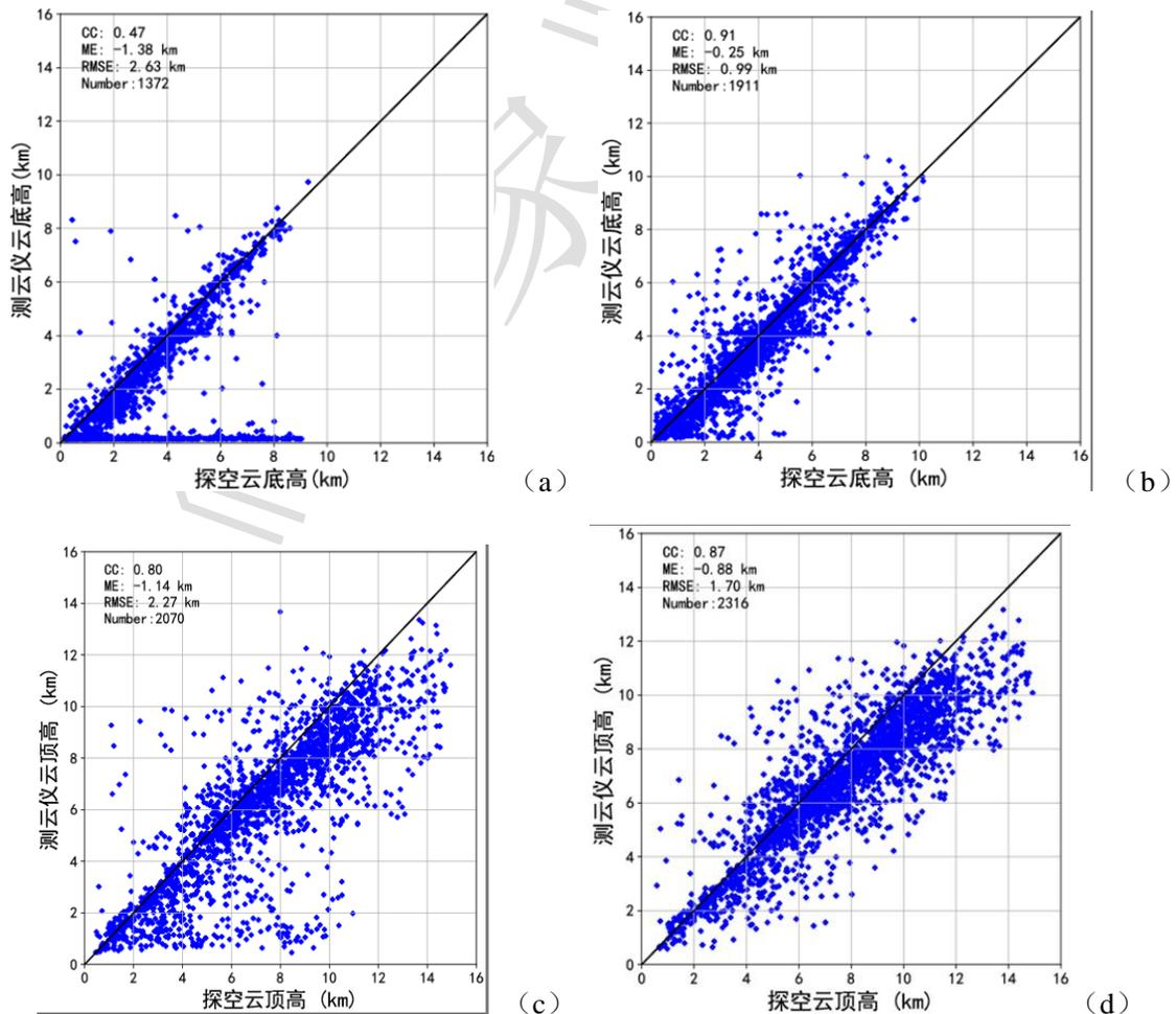
图6 测云仪反射率因子质量控制前 (a、c)、质量控制后 (b、d) 与探空计算的云底高度 (a、b)、云顶高度 (c、d) 的散点图
