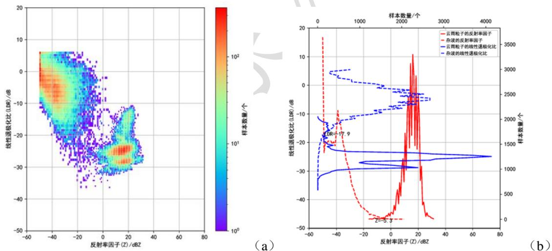
图 3 太原站毫米波测云仪人工标记云雨及杂波 Z 及 LDR 的特征
