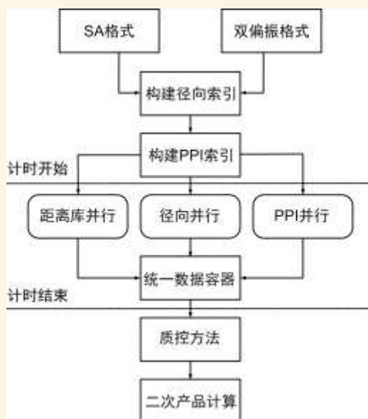
图 6 并行解码测试方案
