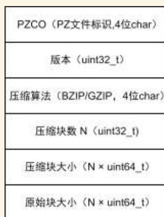
图 3 数据压缩信息的存储结构
