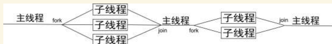
图 2 OpenMP 的 join-fork 模型
