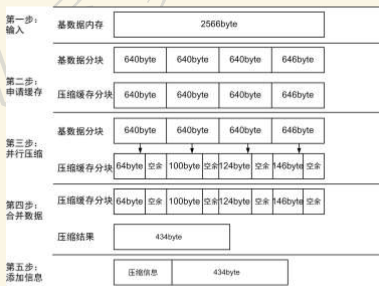
图 4 压缩过程流程图
