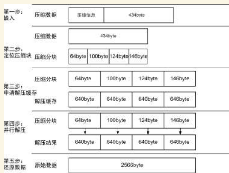
图 5 解压过程流程图
