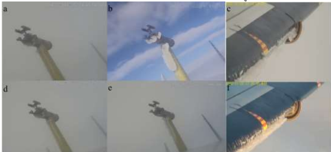
132 图 2 2022 年 1 月 22 日自然结冰取证试飞过程飞机结冰图像
