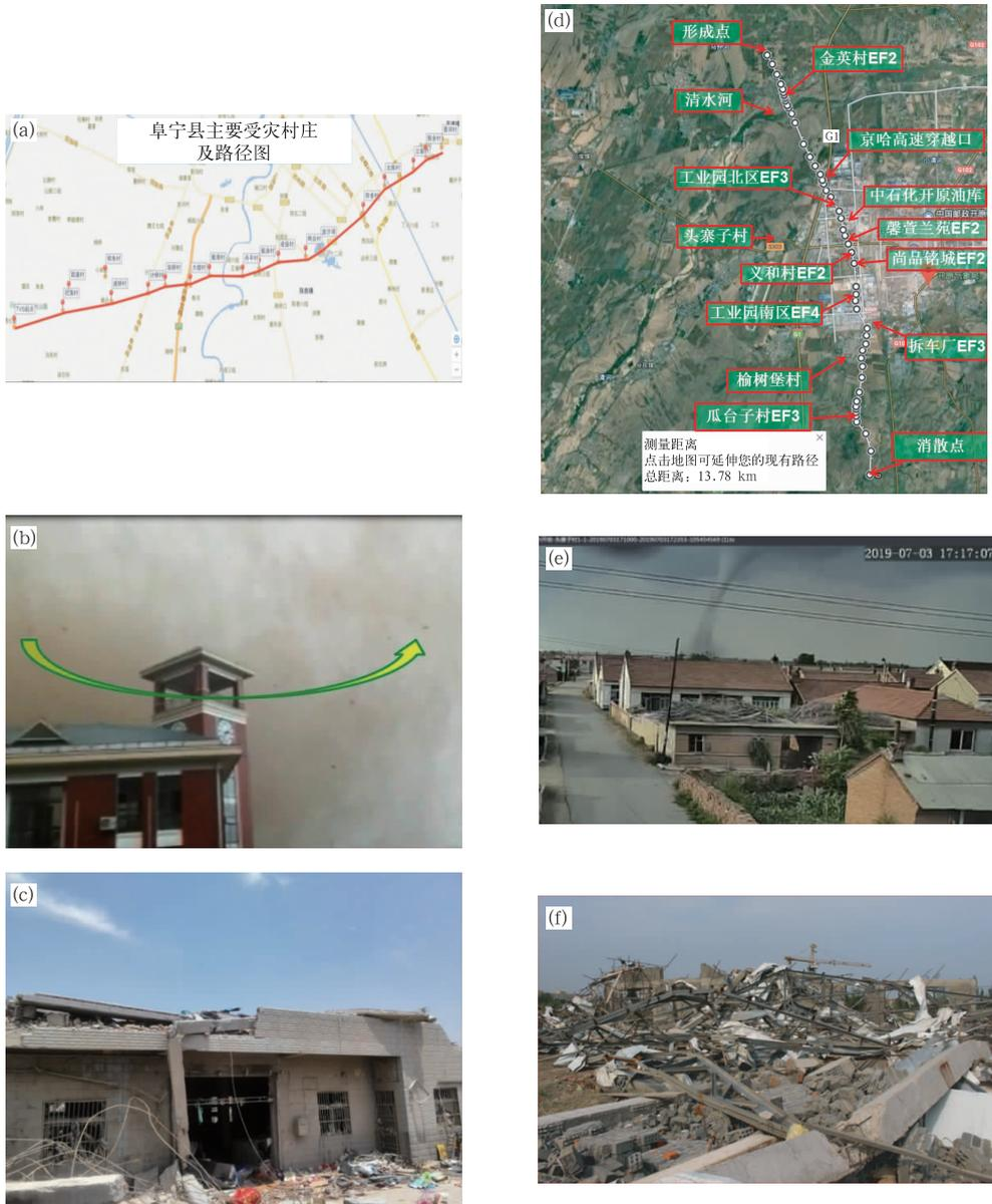
图 3 2016 年江苏阜宁龙卷灾害路径(a),阜宁县吴滩中心小学教师手机拍摄的龙卷漏斗云视频截图(图中箭头表示龙卷旋转方向)(b),立新村受灾二层房屋(c) (郑永光等,2016b);2019 年辽宁开原龙卷路径和强度(d),头寨子村监控视频拍摄的初始龙卷(e),开原工业园南区钢筋混凝土框架结构食堂几乎被夷为平地(f)(张涛等,2020)
