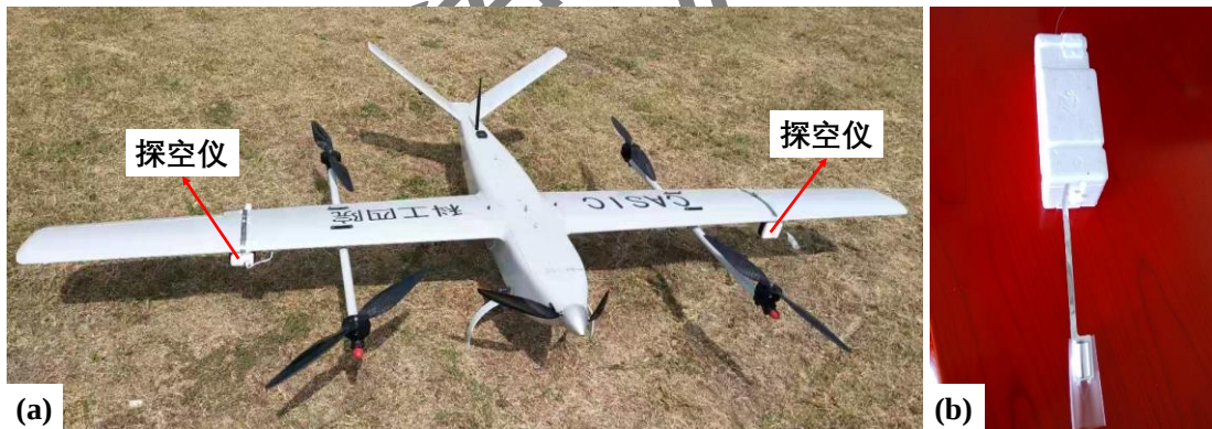
图 1 (a) 试验使用的垂直起降固定翼飞行器及探空仪安装位置示意图; (b) 试验使用的探空仪照片
