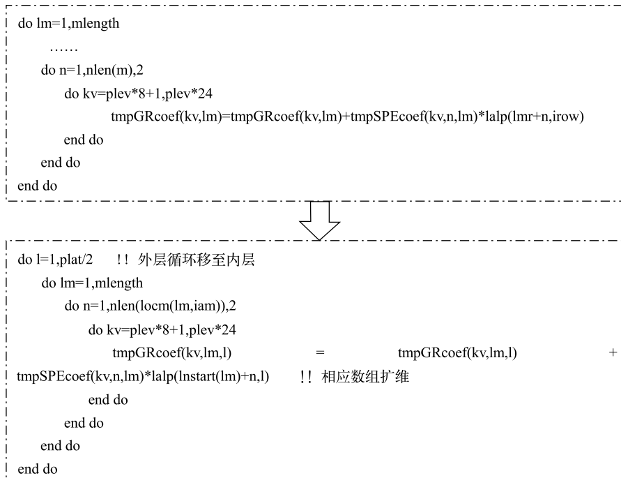
图 3 循环内移及数组扩维 Fig. 3 The cyclic shift and array dimension extension
