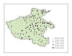
图 9 河南省电力污闪故障发生的风险评估(图中黑色圆点大小代表多年平均的电网污闪故障个数)
