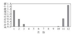
图 8 基于气象综合分析指标计算的 河南地区多年平均的污闪故障 发生个数的月变化
