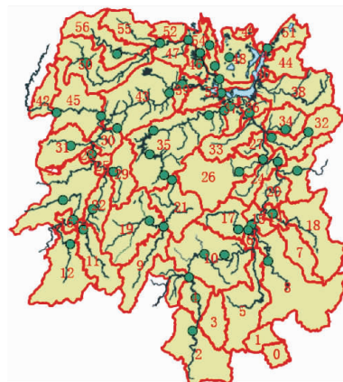
图 1 基于 DEM 高程数据、D8 算法和水文观测站网生成的湖南省中小河流流域 Fig. 1 Distribution of small rivers in Hunan based on D8 algorithm, DEM and hydrological observation
