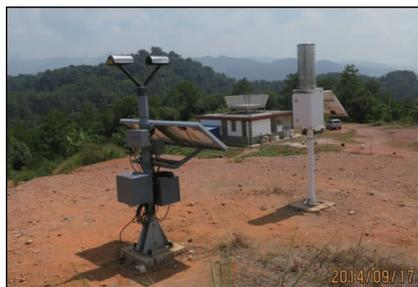
图 1 风廓线雷达、雨滴谱仪和雨量筒位置分布图
