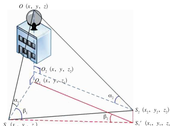
图1 激光全站仪相对高度测量原理
