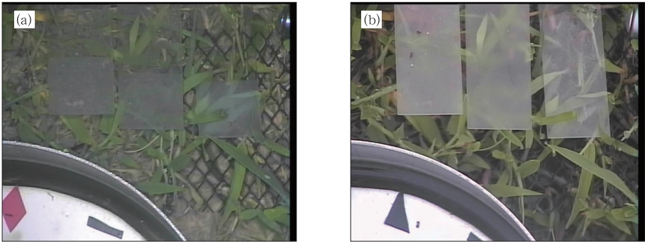
图 1 2010 年 7 月 29 日图像数据 (a)未发生结露现象时的图像,(b)结露现象发生后的图像 Fig. 1 Image data on July 29, 2010 for (a) no dew occurrence and (b) after dew occurrence
