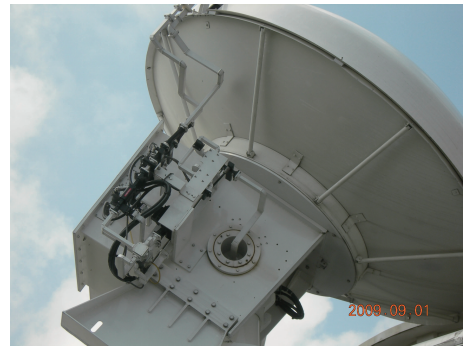
图 4 移动雷达接收机/信号处理器机箱及天馈系统照片
