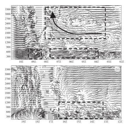
**图 9** 2006 年 7 月 31 日(a)、8 月 1 日(b)海淀风廓线图 时间分辨率为 6 分钟,垂直高度单位:m
