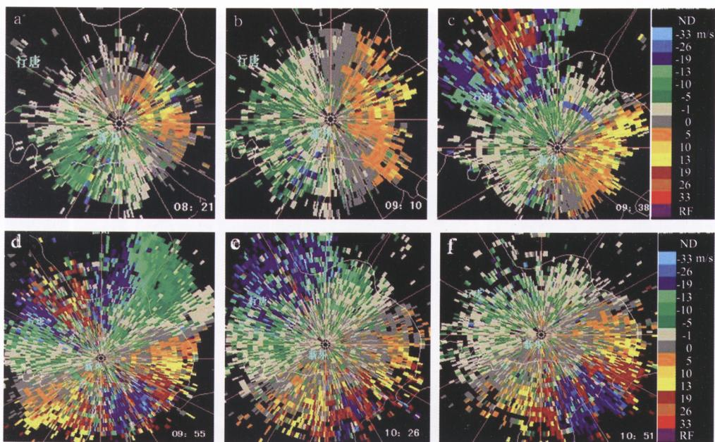
图3 2005年4月20日08:21—10:51多普勒雷达径向速度图
