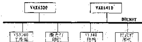
图3 VAX 计算机 T63 图形系统硬件配置图
