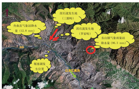
图 1 舟曲特大山洪泥石流灾害示意图
