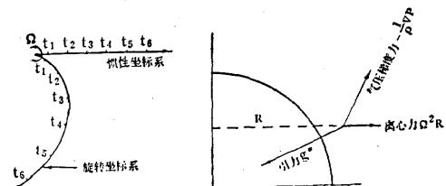
图 2.1 从惯性坐标系与从旋转坐标系观测到的物体运动
