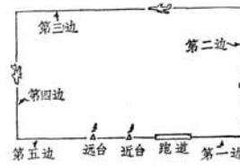
图 1 飞机起落航线示意图
