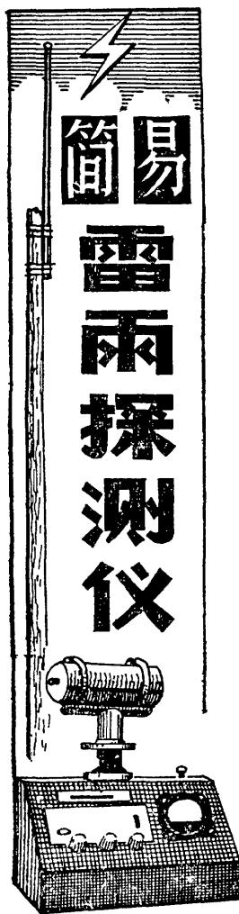
联一个4.7K的可变电阻，使电流起始值稳定在30 $\mu$ A，让电流表指针有回旋的余地；电表接在电源上时，电表并联一段电阻丝，使电流起始值稳定在100 $\mu$ A。上述联结的电表，在电压一定（6V），接收波段一定（400米或570米附近选择无电台广播波段处）的条件下，电流表的电流数值就只随传来的电磁波的强弱而变化。至于传来的电磁波是否为雷雨的电磁波，可以从喇叭传出的声音来判断。
