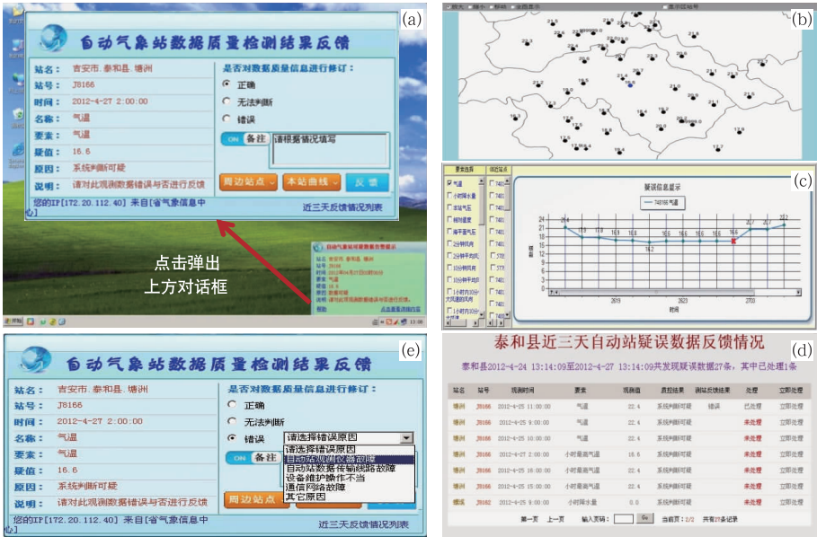
图 9 台站数据质量监控、反馈界面 Fig. 9 Some interfaces for AWS data quality monitoring and feedback
